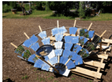
Selbstbau-Parabolspiegel gebrauchte Spiegel 1.5m² (15 €), Glasschneider (10 €), gebrauchter Lattenrost 140 cm (20 €), mit Kleinkram insgesamt ca. 50 €
